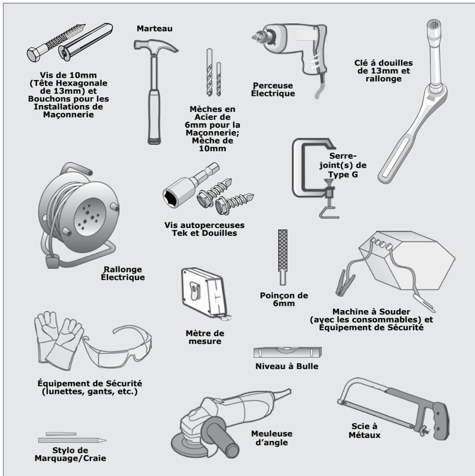
FIGURE 4. OUTILS ET ÉQUIPEMENTS NÉCESSAIRES
