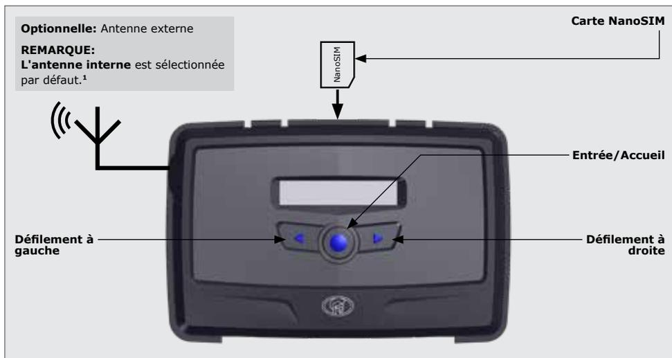
FIGURE 3. PRÉSENTATION DE L'APPAREIL
