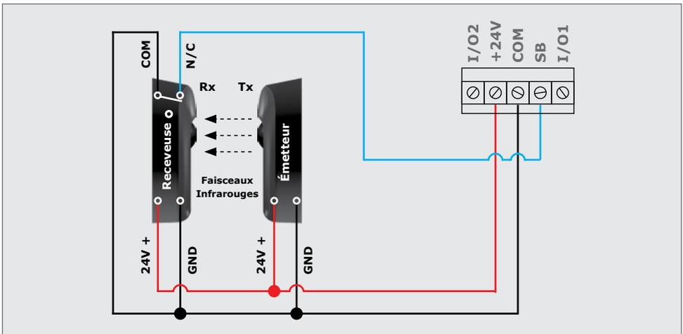
IMAGE 83. CÂBLAGE DES CELLULES DE SÉCURITÉ DE L'I5 SUR SDO4 SMART (QUATRE FILS)
