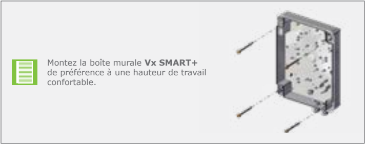
FIGURE 36. FIXEZ LA BOÎTE MURALE Vx SMART+ AU MUR
