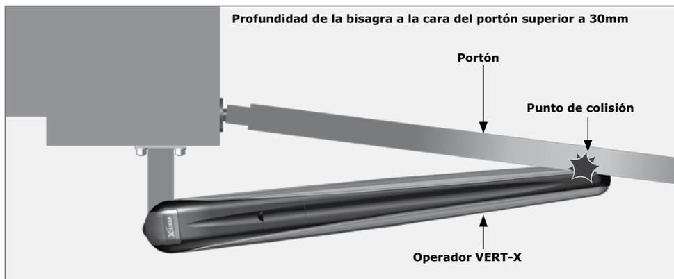
FIGURA 9. OPERADOR EN COLISIÓN CON EL PORTÓN
