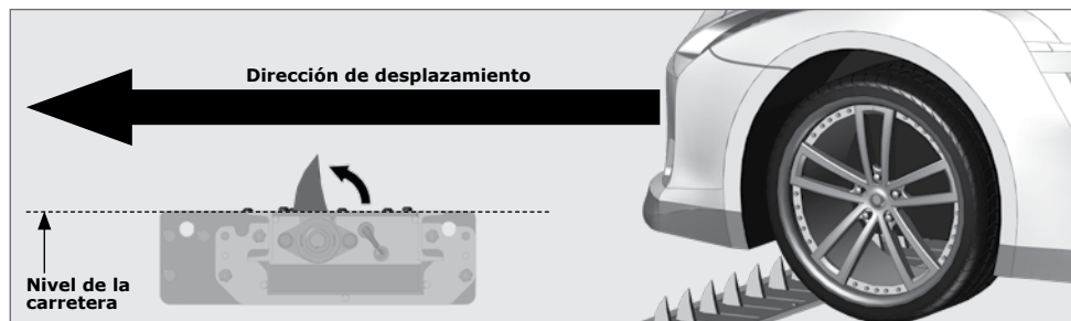
FIGURA 4. DIRECCIÓN DE IMPACTO DE LAS GARRAS - SIMILAR
