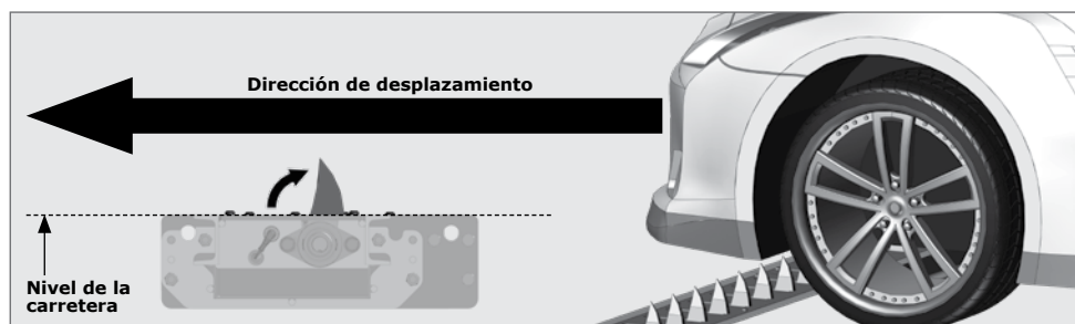
FIGURA 5. DIRECCIÓN DE IMPACTO DE LAS GARRAS - CONTRARIO
