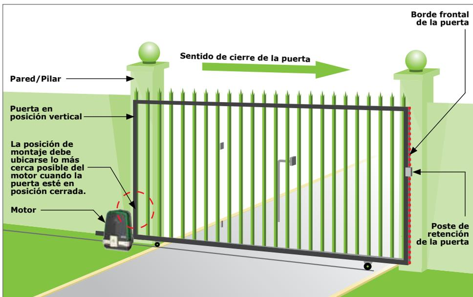
FIGURA 5. POSICIÓN DE MONTAJE
